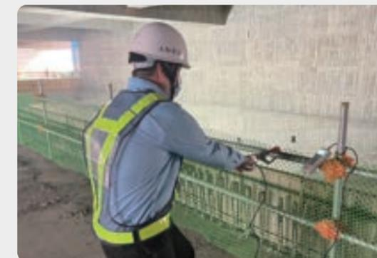
護欄強度拉力計測試
